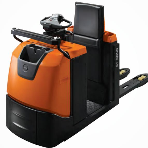
Niederhub-Kommissionierer sind ideal für schnelldrehende Güter. Schnell und einfach zu fahren – optional mit hebbarer Fahrerplattform, hebbarer Gabel und in halbautomatischer Ausführung.
