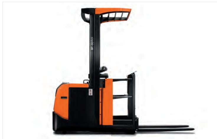
Sicherheit durch Fahrerschutzdach
