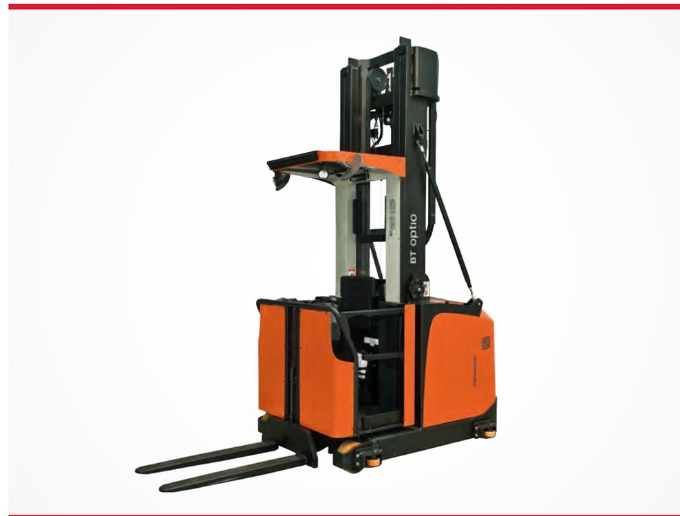
Konzipiert für Schmalgang-Einsätze in der Höhe mit Induktiv- oder Schienenführung. Außerhalb der Gänge ist auch der ungeführte Einsatz möglich.
